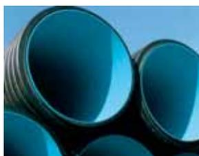
I tubi corrugati in PEAD per fognatura sono costituiti da due pareti fra loro coestruse, la parete esterna corrugata conferisce una elevata resistenza allo schiacciamento, la parete interna liscia consente un' **alta capacità di flusso**.
